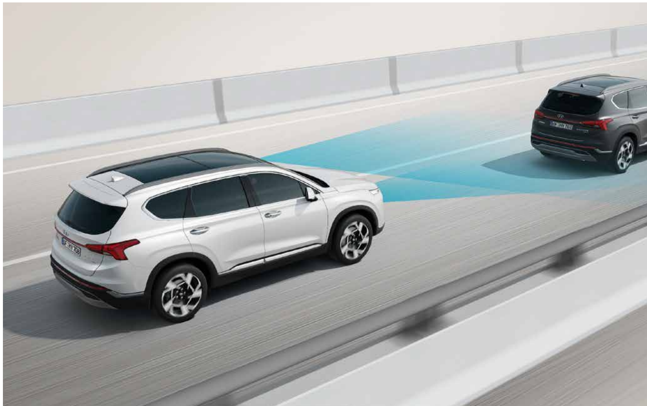
Sistem podrške vožnji na autoputu -Highway Driving Assist (HDA) Drži vas na sredini vaše trake i na sigurnom odstojanju od vozila ispred vas kada je uključen "pametni tempomat" il sistem podrške za ostanak u traci.
