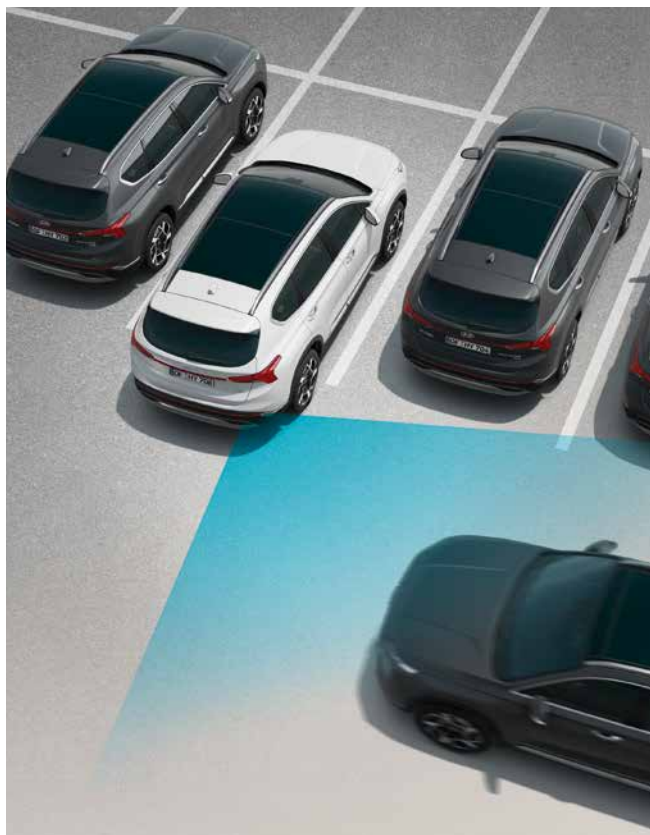
Sistem asistencije pri izbjegavanju unakrsnog udara u vožnji natrag (RCCA) Rear Cross-Traffic Collision-Avoidance Assist (RCCA) - Kada idemo natrag na području sa slabom vidljivošću, sistem ne samo da upozorava vozača, ukoliko vozilo dolazi s bočne strane vozilo automatski koči.
