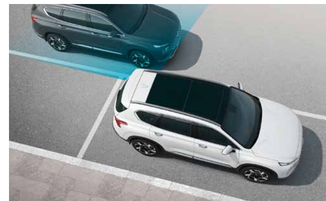
Sistem podrške i detekcije mrtvog ugla. Blind-Spot Collision-Avoidance Assist (BCA) - Koristeći senzore u donjem dijelu zadnjeg bránika i prednju kameru sistem vas upozorava na promet u mrtvom uglu. Ukoliko trebate postaviti upozorenje za takve situacije, ono će zvučati kao zvučno upozorenje i kočenje će spriječiti udes.
